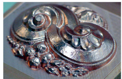
Broschenform aus Bronze für die Schmuckindustrie Brooch mould made of bronze for jewellery
