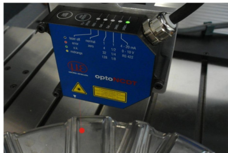
3-D Laserscanner für Digitalisieraufgaben 3-D Laserscanner for digitising jobs
