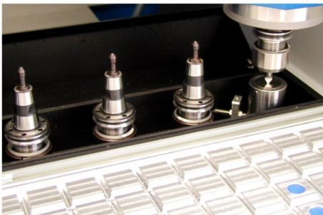
AL-Raster-Vakuum-Arbeitstisch und WZW mit Messdose AL Breadboard vacuum work table and tool changer with tool length sensor
