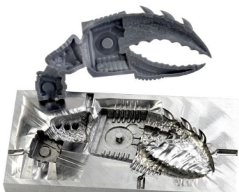
Aluminium-Form mit Kunststoff-Spritzteil Aluminium form with plastic injection part
