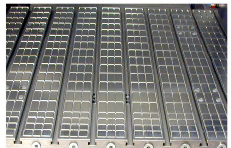
Arbeitstisch mit integriertem Vakuumssystem Work table with integrated vacuum system
