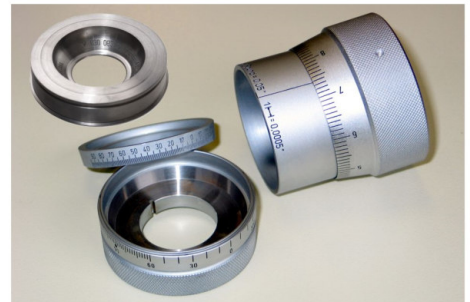
Präzisions-Teiltrommeln für Stichschleifmaschine Precision graduated collars for cutter grinder
