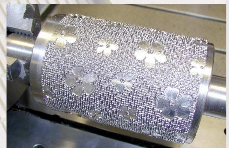
Papier-Prägewalze aus Werkzeugstahl Embossing roller for paper, made of tool steel
