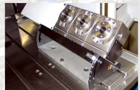
Schwenkbarer Teilkopf 3-spindlig Swivelling indexing head, 3 spindles
