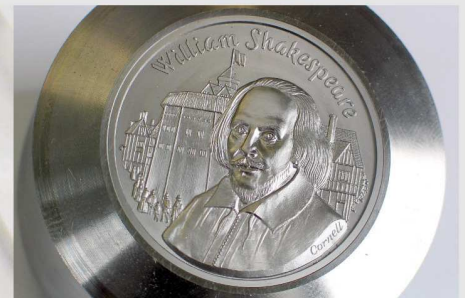
Münz-Prägestempel aus Werkzeugstahl Coining die made of tool steel
