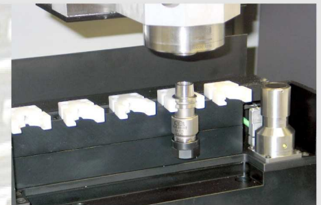
Werkzeugwechsler für Greiferrille mit Messdose Tool changer for gripper groove with load cell
