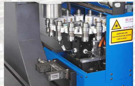
Werkzeugwechsler 16-fach für SK und HSK Tool changer for 16 tools for SK and HSK
