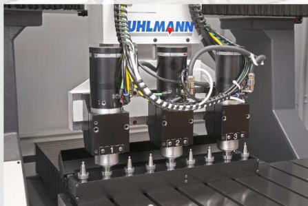
Mehrspindel-Einrichtung mit Werkzeugmagazin Multispindle device with tool magazine
