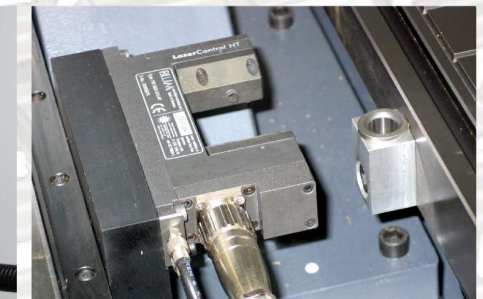
Laser-Werkzeugmesssystem optional Laser tool length measuring system optional
