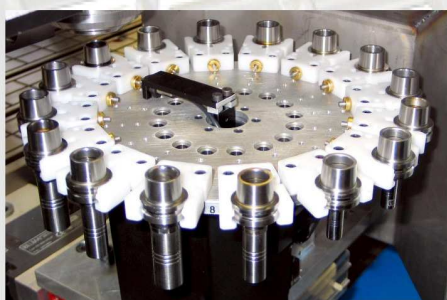
16-fach Wechsler mit Tribos Werkzeugaufnahmen 16fold changer with Tribos tool holders
