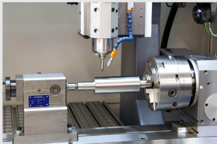
Walzenoption, Ballenlänge bis 1020, Durchmesser 320 Indexing head, barrel length up to 1020, diameter 320
