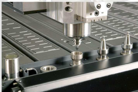
Pick-up-Wechsler mit Messdose optional Pick-up changer with tool length sensor optional
