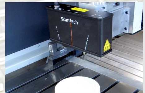
3-D Laserscanner für Digitalisierungsaufgaben 3-D Laserscanner for digitising jobs
