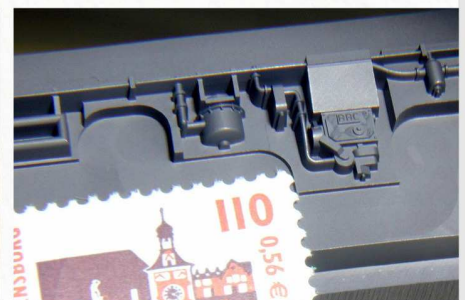
Graphit-Elektrode für den Kleinformenbau Graphite electrode for model making
