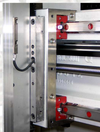
Direktes Wegmesssystem, Glasmaßstab Direct path measuring system, glass scale
