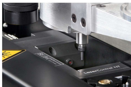
Laser-Werkzeugmesssystem Laser tool length measuring system
