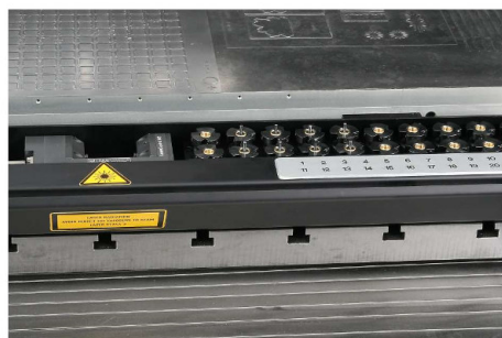
Werkzeugmagazin mit integriertem Laser Tool magazine with integrated laser
