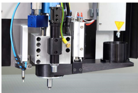
Kamera, Frässpindel und Staubabsaugung Camera, milling spindle and dust extraction
