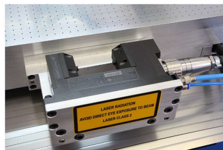
Laser Werkzeugmesssystem Laser tool length measuring system
