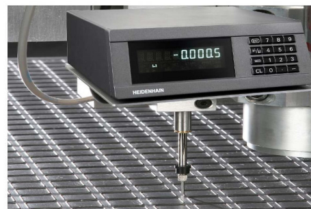
Inkrementaler Messtaster mit Anzeige Incremental measuring calliper with value indicator
